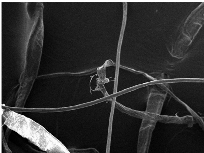
Εικ. 2. Μικροφωτογραφία στο ηλεκτρονικό μικροσκόπιο σάρωσης (SEM) του Τμήματος Συντήρησης Έργων Τέχνης και Αρχαιοτήτων της Σχολής Γραφικών και Καλλιτεχνικών Σπουδών του ΑΤΕΙ Αθηνών. Το Souper Dress φόρεμα, όπως φαίνεται στο ηλεκτρονικό μικροσκόπιο σάρωσης: οι αμιγώς χάρτινες ίνες είναι πεπλατυσμένες και οι συνθετικές στρογγυλές. © ΑΤΟΠΟΣ cvc Paper Dress Collection, Athens.
