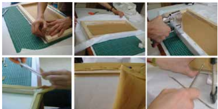
Εικ. 5. Η διαδικασία κατασκευής του συστήματος «pressure mounting».
